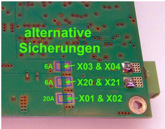
Abbildung 17: Lage der Sicherungen für die Motoren
