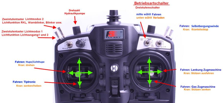
Abbildung 1: Beispielhafte Senderbelegung eines 8 Kanal Senders
