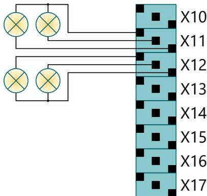
Abbildung 18: Rundumlichtverdrahtung
