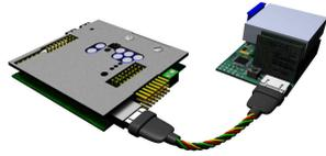
Abbildung 12: Scalebusverbindung zwischen einem FO-Modul und einem Regler
