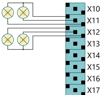
Abbildung 16: Rundumlichtverdrahtung
