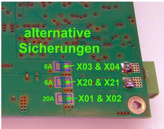
Abbildung 15: Lage der Sicherungen für die Motoren
