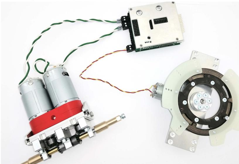
Abbildung 13: Wird unser Getriebe hinten in das Fahrzeug gebaut, wird der linke Motor (in Fahrtrichtung) an X01 angeschlossen. Weiße Leitung an X01+, grüne Leitung an X01-. Der rechte Motor (in Fahrtrichtung) wird an X02 angeschlossen. Weiße Leitung an X02+, grüne Leitung an X02-.
