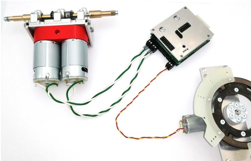
Abbildung 12: Wird unser Getriebe vorne in das Fahrzeug gebaut, wird der linke Motor (in Fahrrichtung) an X01 angeschlossen. Weiße Leitung an X01+, grüne Leitung an X01-. Der rechte Motor (in Fahrrichtung) wird an X02 angeschlossen. Weiße Leitung an X02+, grüne Leitung an X02-.
