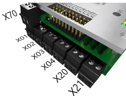
Abbildung 11: Motorsteckverbinder
