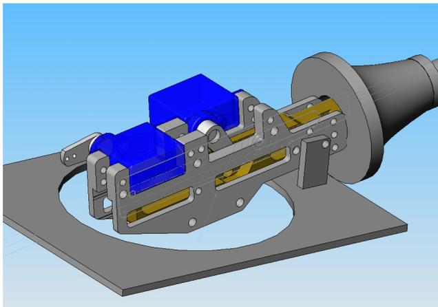
Abbildung 10: Beispiel einer Rohranhebe und Rückzugseinheit mit Servos
