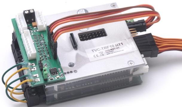
Abbildung 20: TVC-HRF-AD3 montiert auf dem FO Module
