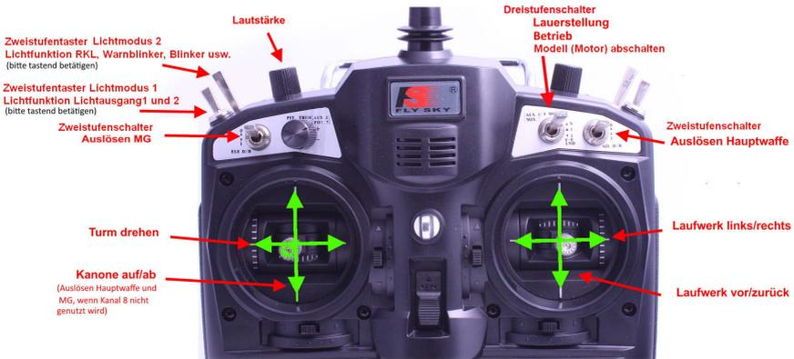
Abbildung 1: Beispielhafte Senderbelegung
