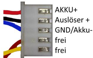
Abbildung 15: Belegung der Tamiya Blitzeinheit
