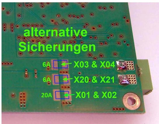
Abbildung 14: Lage der Sicherungen für die Motoren
