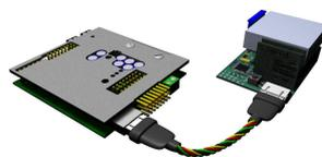
Abbildung 11: Scalebusverbindung zwischen einem FO-Modul und einem Regler
