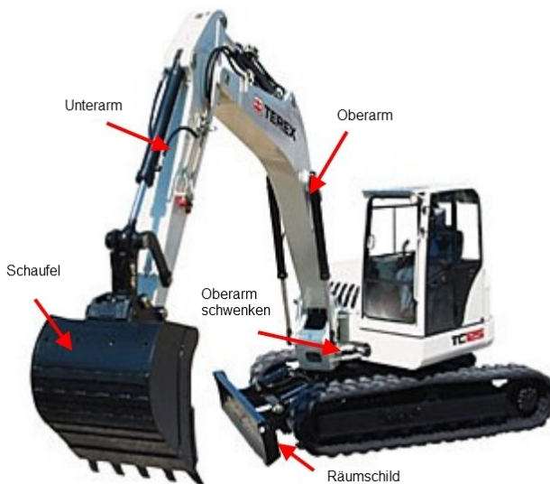
Abbildung 10: Zuweisung der Hydraulikventile für Minibagger
