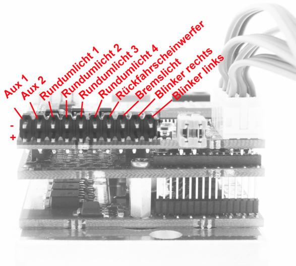
Figure 6: Belegung der Lichtausgänge
