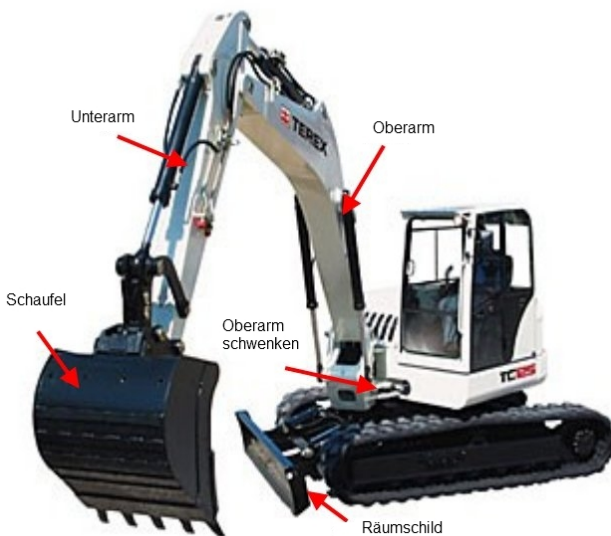
Abbildung 10: Zuweisung der Hydraulikventile für Minibagger
