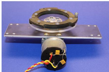
Das ist bei der zweiten Auflage, die als Standmodell konzipiert ist, eingespart worden. Man kann relativ einfach Aluprofile (40 x 10 x 1,5mm) montieren, um den Innenraum wieder zu schliessen.
