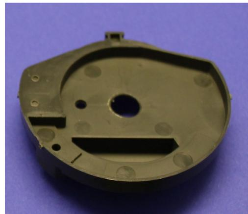
Stecken Sie die Lagerbuchsen von innen in das Turmgehäuse und stecken Sie die Stahlwelle hindurch. Die rechte Bohrung ist 11mm und die Bundbuchse nur 10mm, daher muss vor dem Einkleben die Buchse genau zentriert werden. Klemmen Sie sie dazu von außen mit zentrisch provisorisch ein, bis der Kleber ausgehärtet ist.
