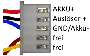
Abbildung 15: Belegung der HL Blitz- einheit
