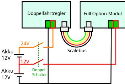
Abbildung 5 zeigt den Fall, dass verschiedene Module mit verschiedenen Spannungen betrieben werden, zum Beispiel wenn der Hauptantrieb mit 24V betrieben wird und die Nebenantriebe und Licht mit 12V. Auch hier ist es wichtig, **nur** die **Plus**-Zuleitungen zu schalten.
