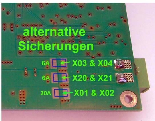
Abbildung 16: Lage der Sicherungen für die Motoren
