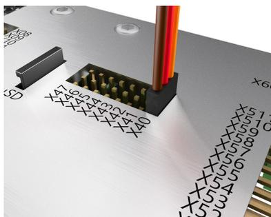
Abbildung 8: Futaba Servos haben einen Kunststoffnase, die entfernt werden muss
