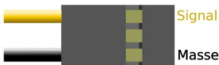
Sie können auch elektronische Sensoren verwenden, z.B. induktive Näherungsschalter aus der Industrie. Diese machen den Bau der notwendigen Bereichsabtastung/Nockenbahn einfacher. Elektronische Schalter müssen für 5V Betriebsspannung ausgelegt sein und einen sog. Open Collector Ausgang haben.
