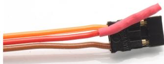
*Abbildung 4: entfernte und isolierte + Zuleitung im Servostecker*
