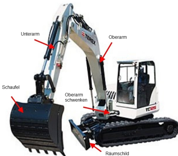
Abbildung 12: Zuweisung der Hydraulikventile für Minibagger
