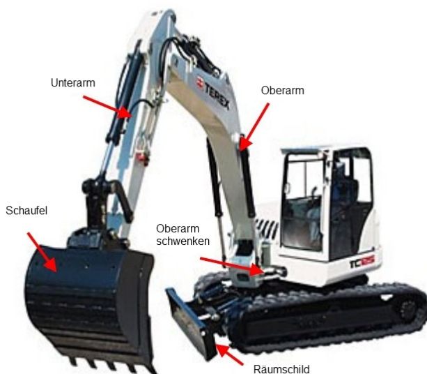
Abbildung 12: Zuweisung der Hydraulikventile für Minibagger
