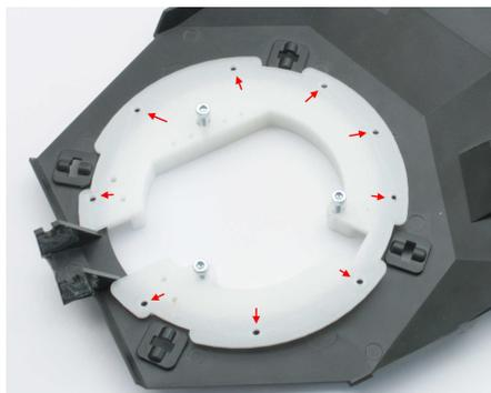
Nutzen Sie die mitgelieferten M2x6 Senkkopfschrauben und Muttern um den Ring zu verschrauben. Die Schrauben werden von unten eingesteckt, die Muttern sind also im Turm.
