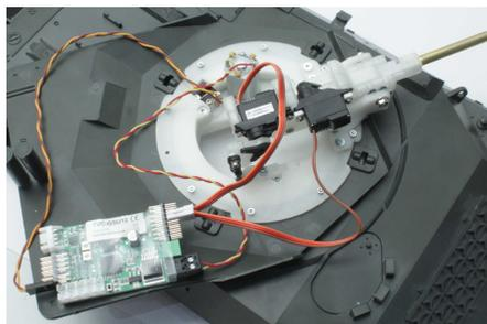
Beachten Sie das die beiden unteren Kontakte von X7 belegt sind, der orange Crimpkontakt muss daher in die Mitte des Steckers verlegt werden.
