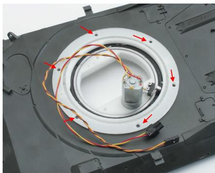
In die Bohrlöcher werden die mitgelieferten M3x8 Senkkopfschrauben steckt und von unten mit den M3 Bundmuttern gesichert.
