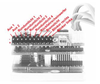
Figure 6: Belegung der Lichtausgänge
