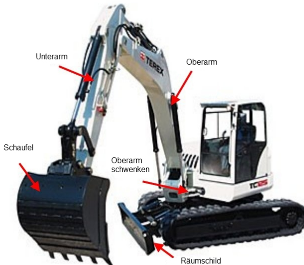
Abbildung 10: Zuweisung der Hydraulikventile für Minibagger
