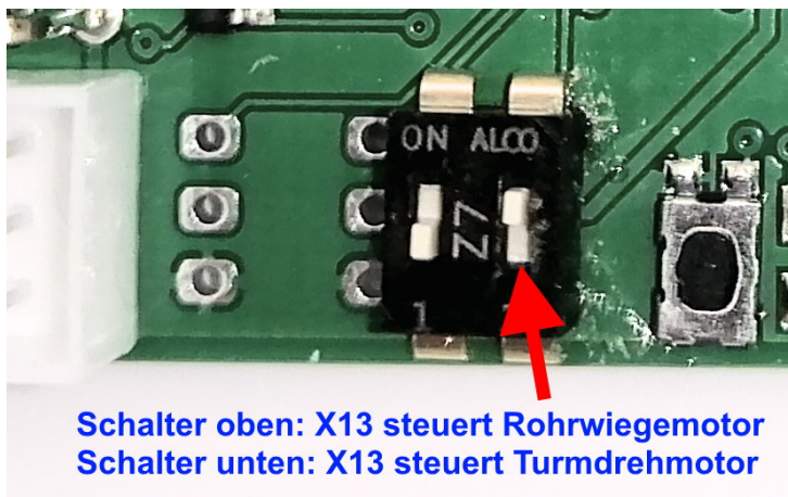
Abbildung 6: Schalter zur Auswahl der Funktion des Fahrreglerausgangs X13 Nach Ändern des Schalters muss das Modul neu gestartet werden.
