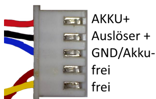
Abbildung 11: Belegung der HL Blitzeinheit
