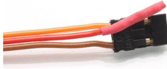
*Abbildung 5: entfernte und isolierte + Zuleitung im Servostecker*
