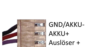
Abbildung 13: Belegung der Tamiya Blitz- Blitzeinheit
