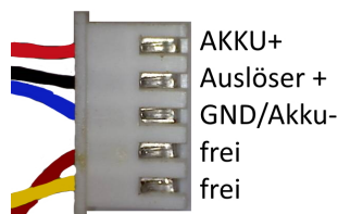
Abbildung 16: Belegung der HL Blitz-einheit
